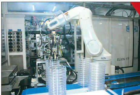
Le robot qui assemble les boîtes propres et les met en sachet.
